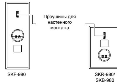
Для горизонтального монтажа центральной акустической системы воспользуйтесь двумя проушинами для акустической системы и двумя надежно закрепленными в стене шурупами.
